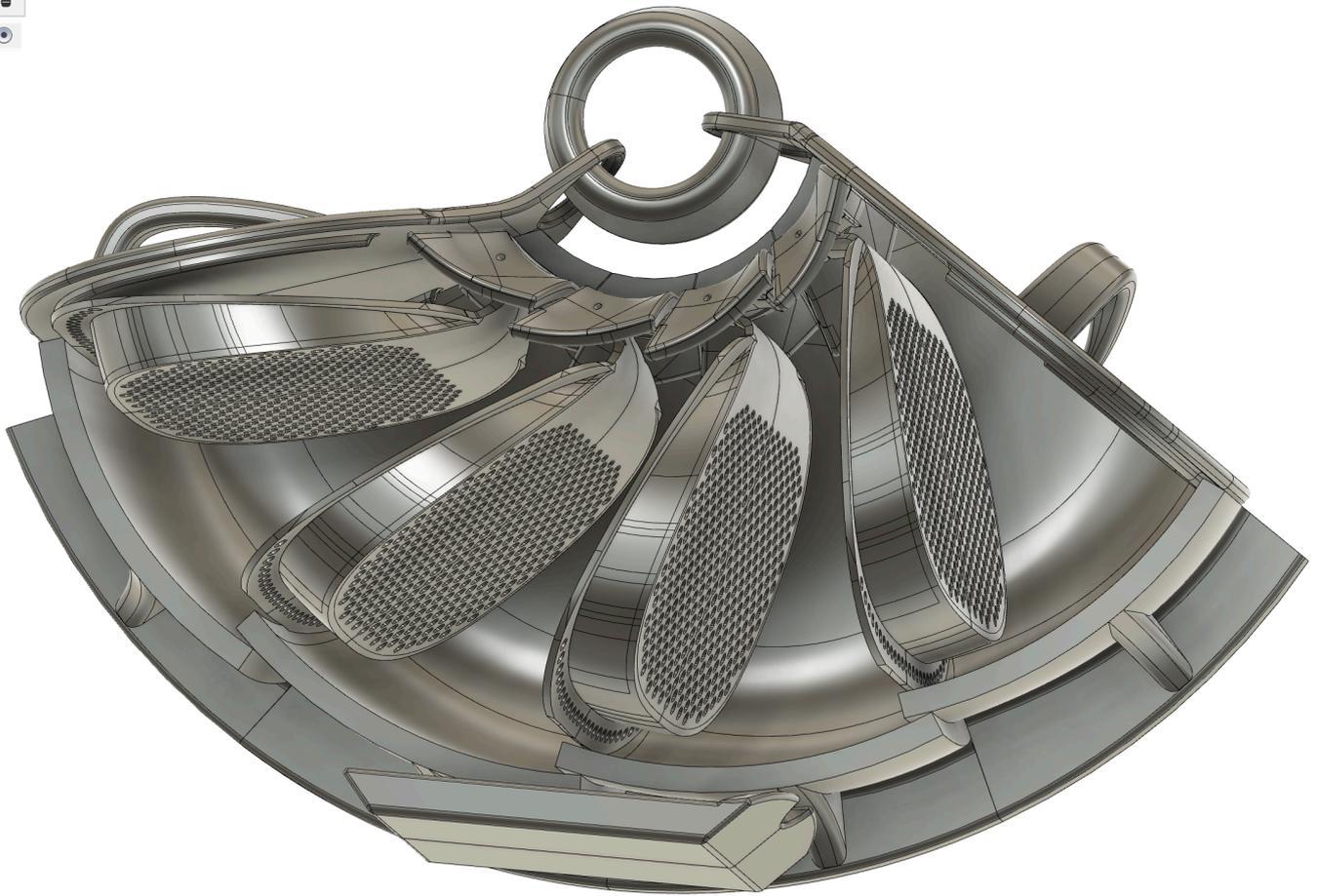
Dies ist der letzte Konzeptentwurf, wo man auch das innere mit den drehbaren Gittern sieht, die äussere konische Schale, die zwei Deckel, und die untergesetzte Schale.
