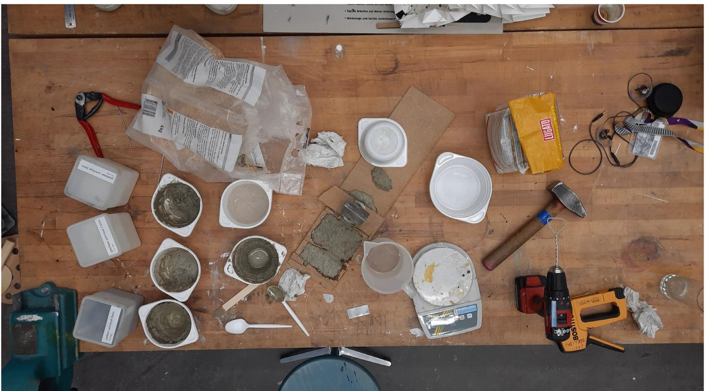
Das Material des Komposter spielt eine sehr wichtige Rolle. Das innere Klima für die Würmer muss feucht gehalten werden. In meinem Materialtesting befasste ich mich mit Beton. Beton charakterisiert, dass es Wasser gut aufsaugt wie auch dass es Wasser Permeabilität.
