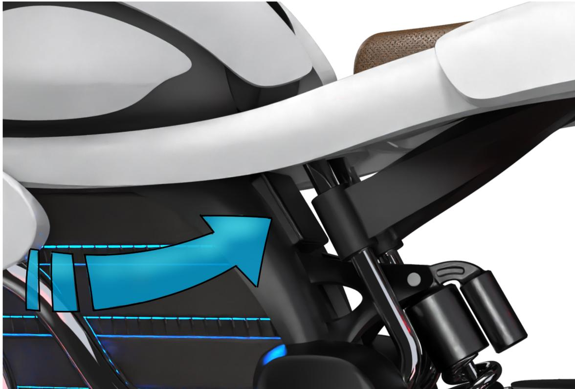
Die Sicherungen befinden sich ausserhalb des Motorgehäuses, damit man möglichst einfach darankommt, um am Motorrad sicher arbeiten zu können. Der Sicherungskasten selbst befindet sich gleich oberhalb der Hinterradfederung, zwischen den Slider Stangen für die Rückbank (markiert mit dem blauen Pfeil).
