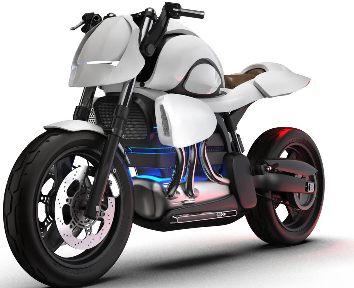
Abb!': Ne'rid im ausgeschaltetem Zustand. Der Spalt zwischen oberer und unterer Scheinwerferabdeckung dient hier noch als Standlicht.
