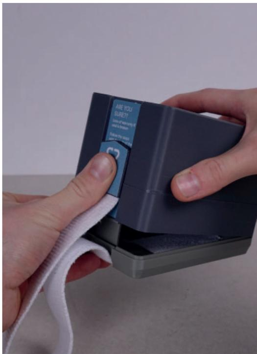
Abb 31. Entriegeln des Gehäuses mit dem Werkzeug.
