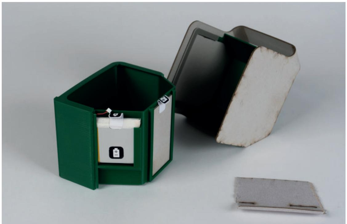
Abb 59. Der Akku und die Leiterplatin sind im Prototyp verbaut, mit einfacher Zugänglichkeit für das Recycling und die Reparatur.
