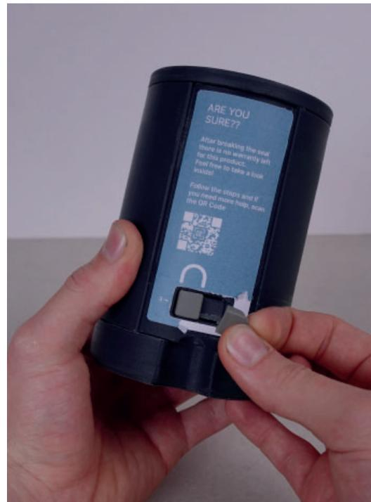
Abb 24. Entfernen der Rotationsverriegelung
