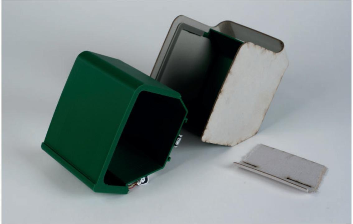
Abb 58. Der Prototyp mit den drei Hauptbestandteilen, dem Kern, die Verschaltung und dem Deckel.
