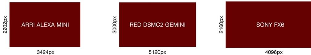
Abbildung 8: Grössenunterschied der Kamerasensoren.
