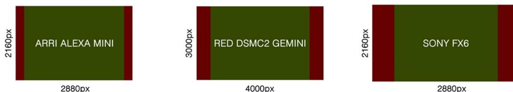
Abbildung 9: Benutzte Sensorfläche für Vergleich.
