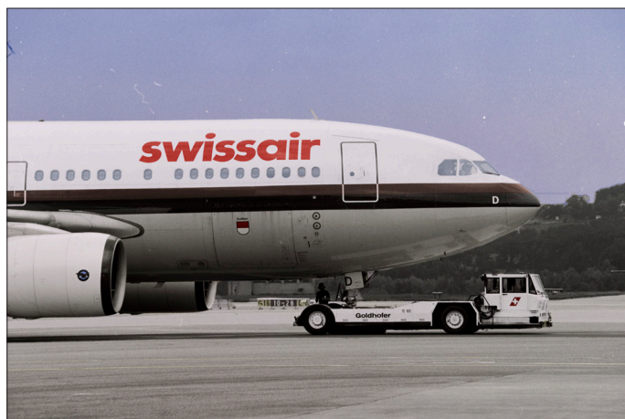
Abb. 3: Der erste stangenlose Prototyp von Goldhofer: AST-1, Kloten, 1992.
