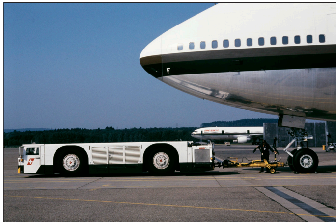
Abb. 2: Pushback-Traktor mit Stange, Kloten, 1983.
