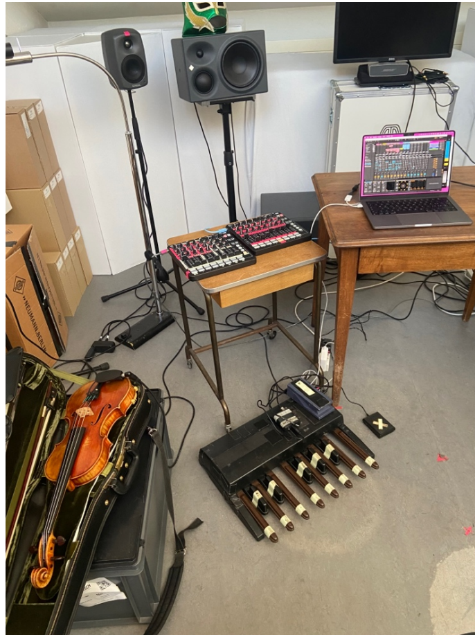
Abbildung 9: Setup Violine mit Ableton Live und 2x Novation Midi Controller, 1 Bass Fusspedal Midi Controller, 1x Boss Expression Pedal und 1x Midi Expression Converter
