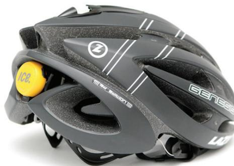
Abb. 24: Icedot Crashsensor an einem Helm befestigt
