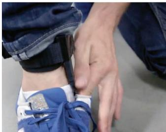
Abb. 28: SolePower in Schuh mit Akku am Fussgelenk
