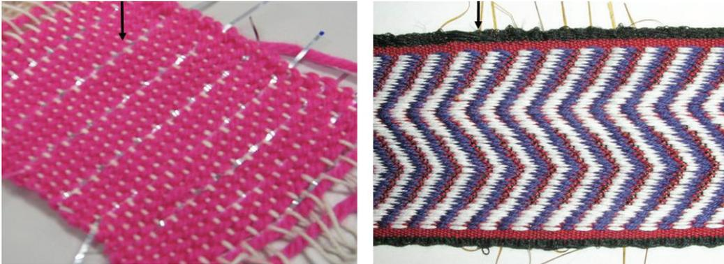
Abb. 31: Eingewobene Sensorik-Streifen des Wearable Computing Lab, ETH Zürich
