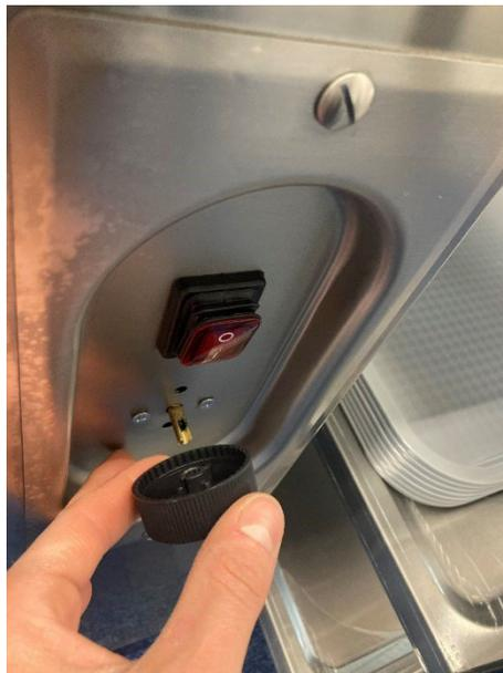
Abbildung 61: Drehregler mit gerillter Oberfläche, Showroom Gastroheld
