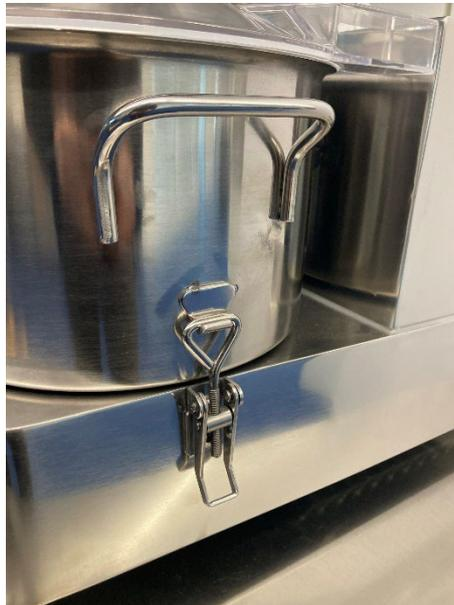
Abbildung 6: Befestigung eines Topfs über einen Spannverschluss, Showroom Gastroheld
