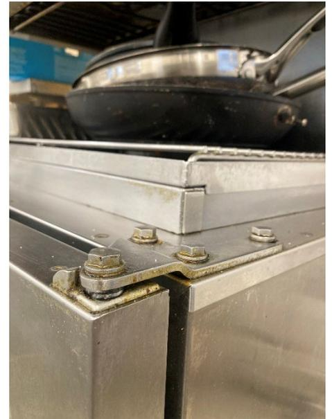
*Abbildung 30: Verschmutzung am Scharnier eines Kombiofens, Verschmutzung am unteren Ende eines Kombiofens, Restaurant Trambly*
