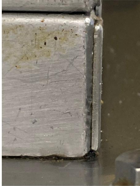
*Abbildung 29: Verschmutzung am unteren Ende eines Kombiofens, Restaurant Trambly*
