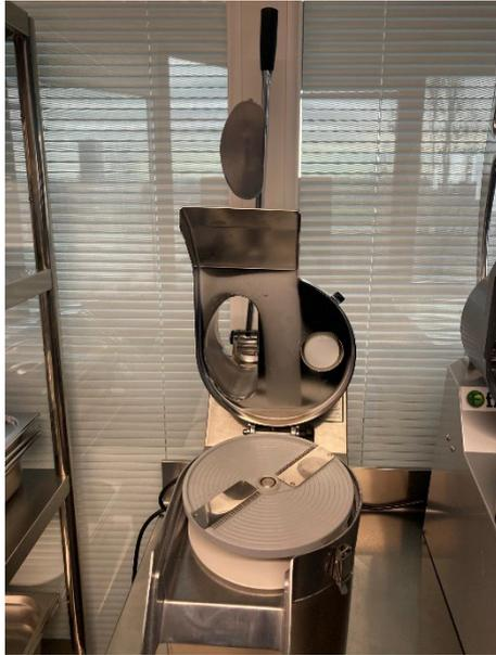
Abbildung 13: Geöffnete Gemüseraffel, Sicht auf die Messer, Unterseite der Stopfen (Metall und Kunststoff), Showroom Gastroheld
