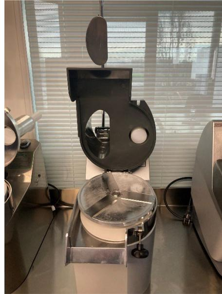
Abbildung 12: Geöffnete Gemüseraffel, Sicht auf die Messer, Unterseite der Stopfen (Metall und Kunststoff), Showroom Gastroheld
