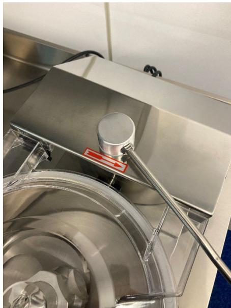
Abbildung 21: Aufkleber zur Anzeige der Drehrichtung des Rührwerks, Showroom Gastroheld
