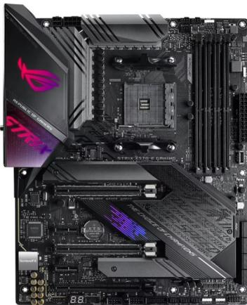
Abb 22 Mainboard mit normierte angeordneten Steckplätzen
